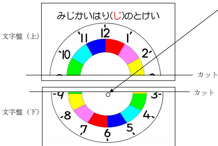
④プラダン（たて45cm よこ40cm）の下から21cmのところに線を引いておく。図のように両面テープを貼る。文字盤（上）を中央に引いた線に合わせ、上部の両面テープで固定する。
